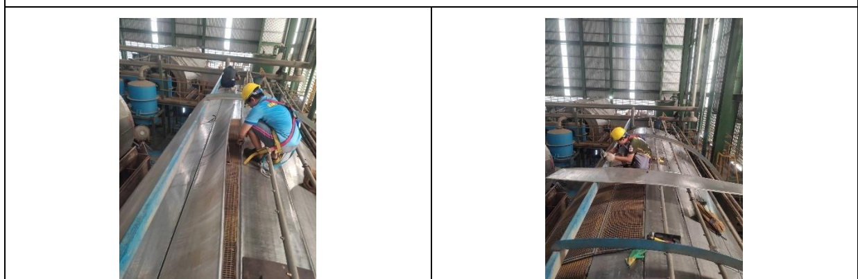
รูปที่ 17 การทำความสะอาดหม้อกรองน้ำอ้อย
