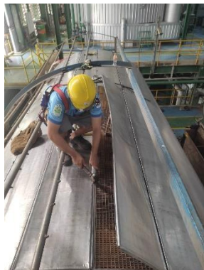
รูปที่ 17 การทำความสะอาดหม้อกรองน้ำอ้อย (ต่อ)
